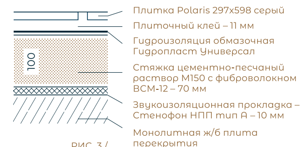
РИС. 3 / ПИРОГ ПОЛА В САУЗЛАХ И ВАННЫХ КОМНАТАХ
