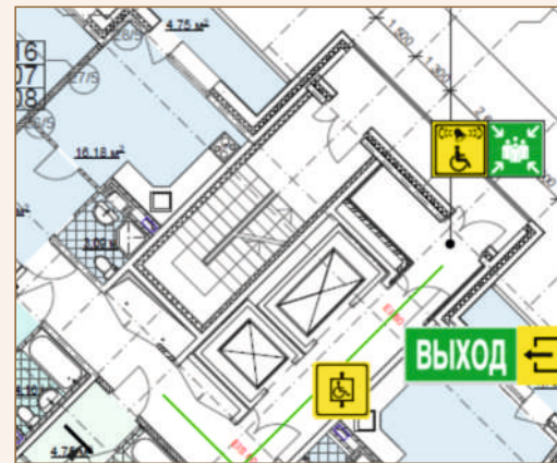
РИС. 1 / ЗОНА ДЛЯ ММГ ЗА ЛИФТОВЫМ ХОЛЛОМ В СЕКЦИЯХ С НЕЗАДЫМЛЯЕМЫМИ ЛЕСТНИЦАМИ ТИПА Н1
